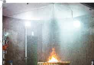
スプリンクラー消火実験
