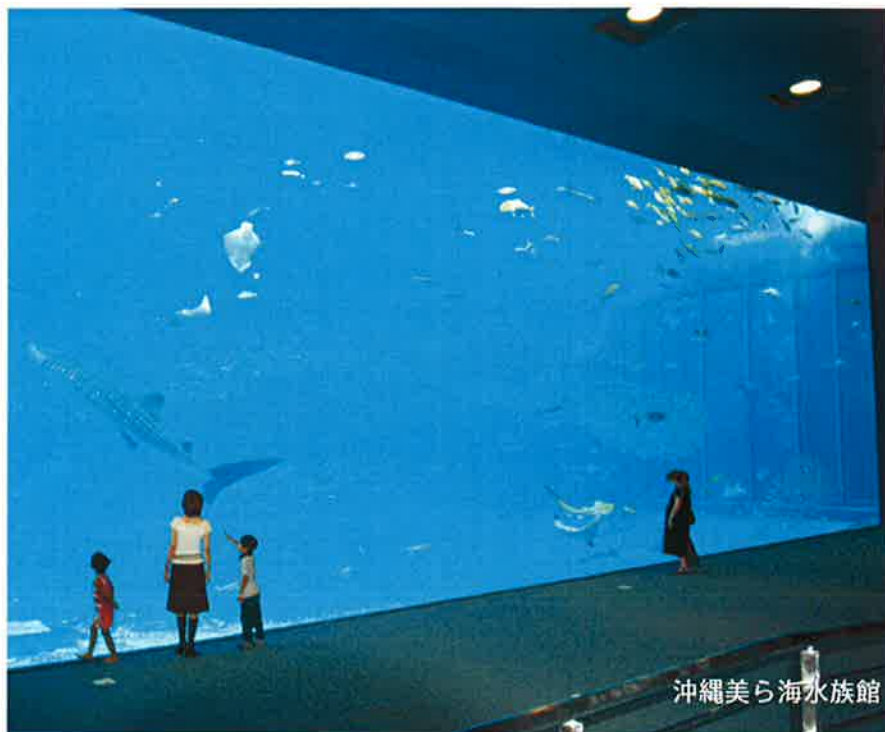
“世界最大アクリルパネル” 2003年度ギネス認定 幅 22.5m × 高さ 8.2m × 厚さ 60cm
