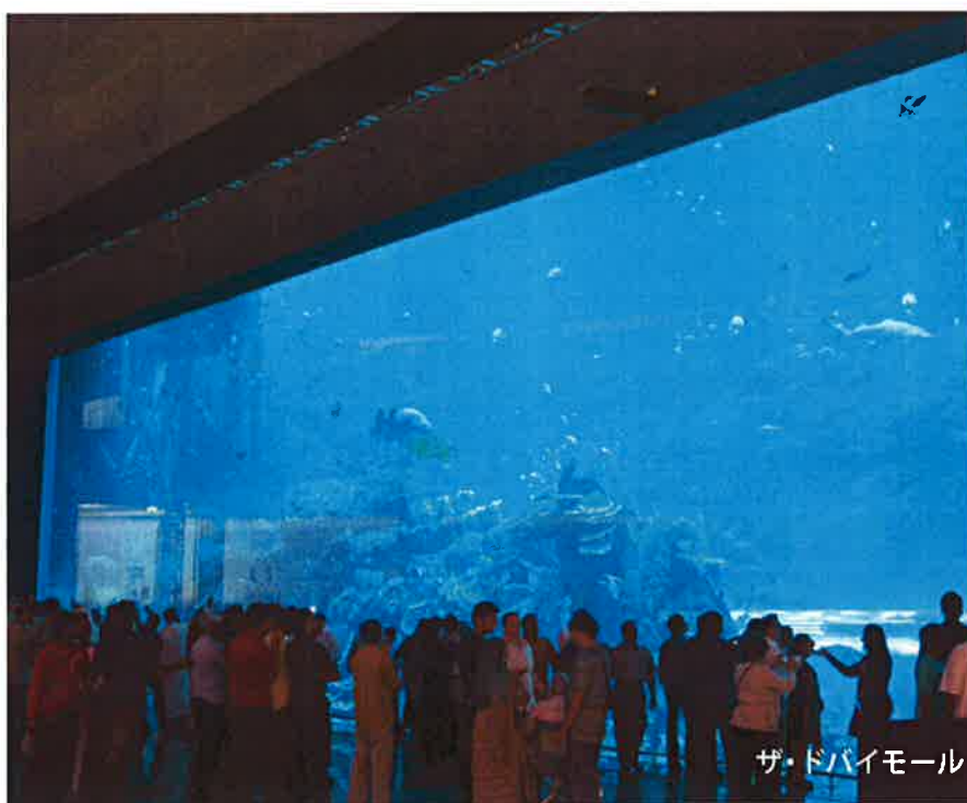
“世界最大アクリルパネル” 2008年度ギネス認定 幅 32.88m × 高さ 8.3m × 厚さ 75cm
