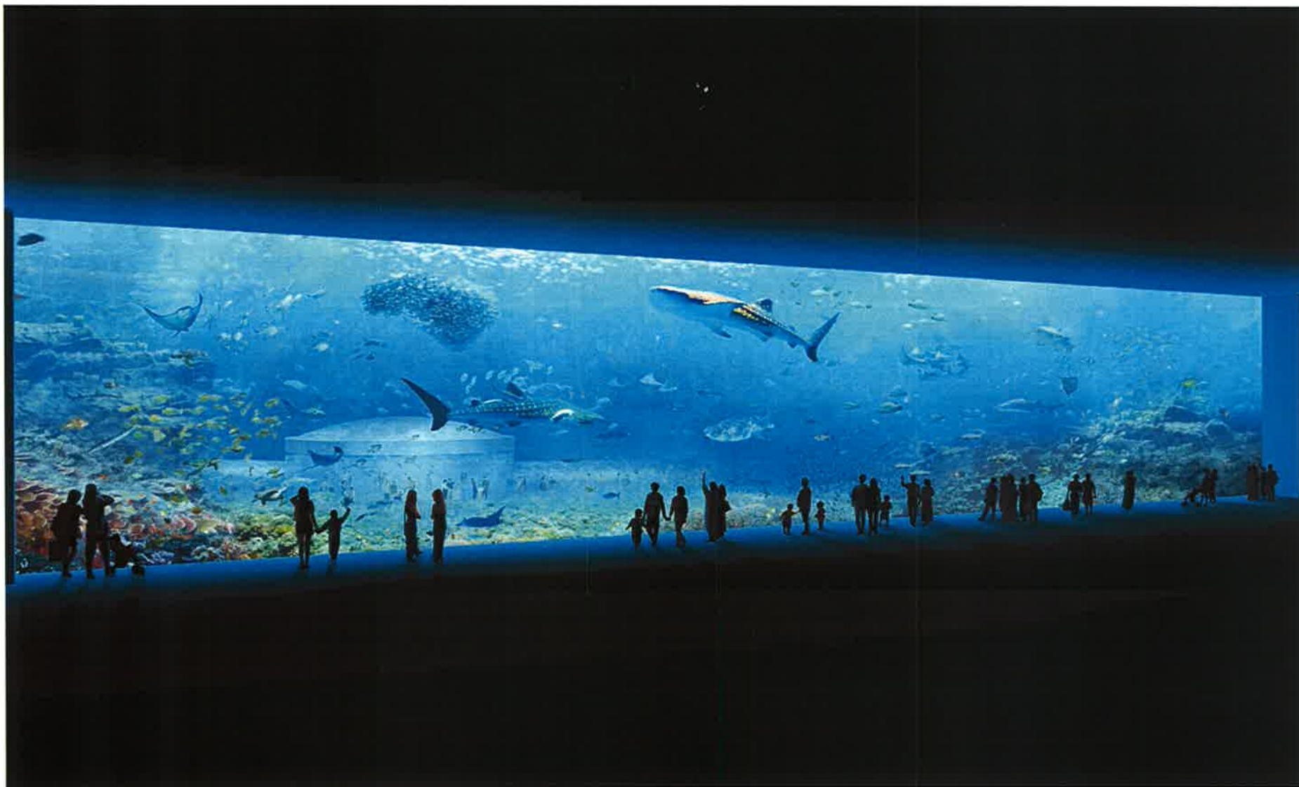
世界最大アクリルパネル (幅39.6m×高さ8.3m×厚さ64.5cm)
