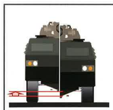
車両底板を持ち上げることで爆風効果を低減 Raising chassis to deflect the blast effect
