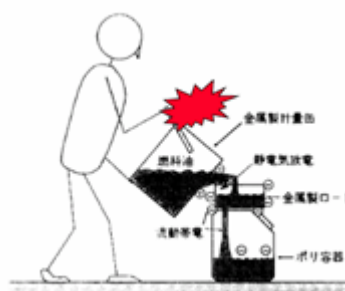
図6 ポリエチレン缶による移し替え作業中の火災
