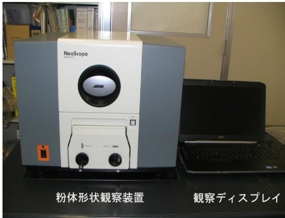
図 走査電子顕微鏡
