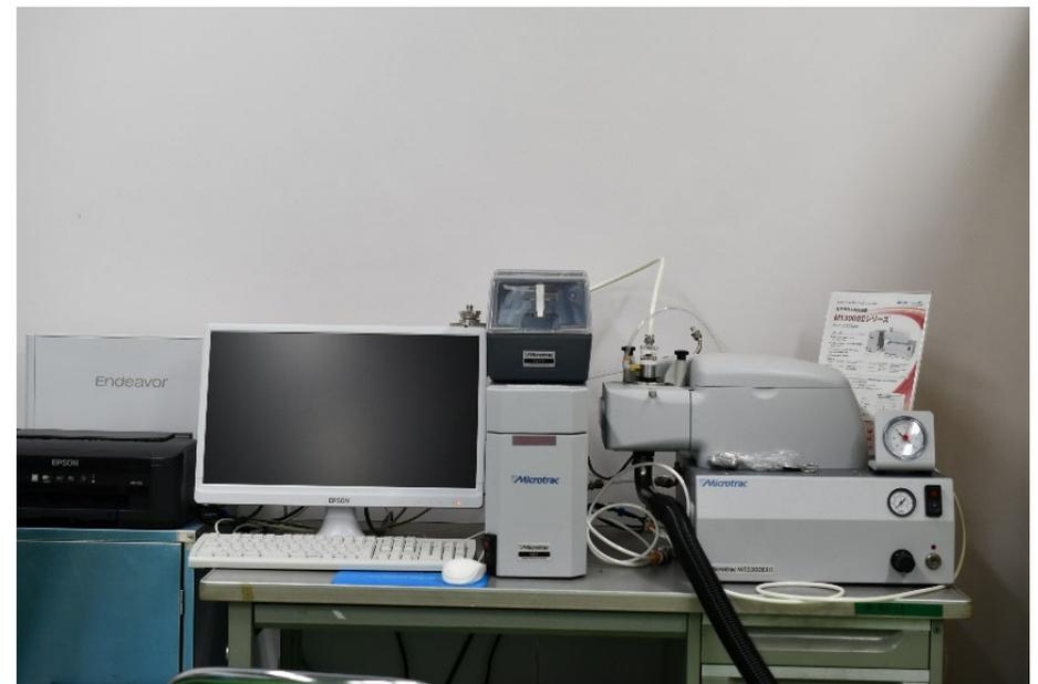
図 レーザー光式粒度分布測定装置
